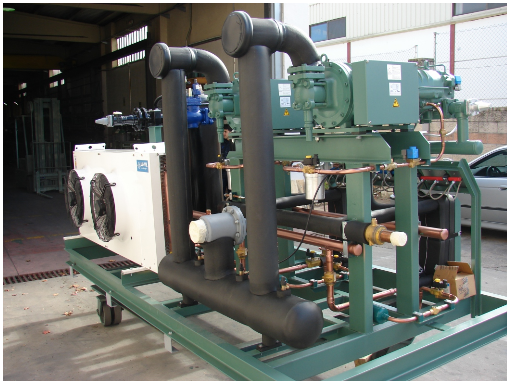
- CENTRAL DE TORNILLO DE 2 COMPRESORES BITZER HSN: ACNT 2 X HSN7471-75 (-30/+45°C) R449A, Pot f = 143,4 kW
