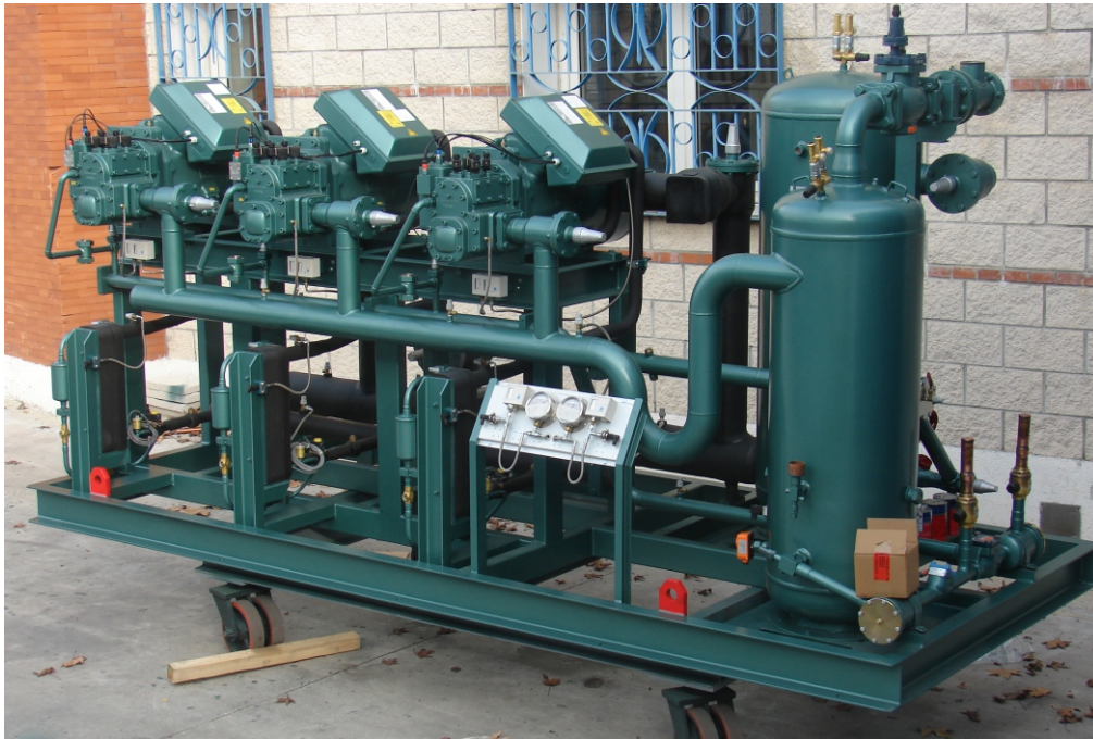
CENTRAL DE TORNILLO DE 3 COMPRESORES BITZER HSN ACNT 3 X HSN7471-75 (-30/+45°C) R449A, Pot f = 215 kW
