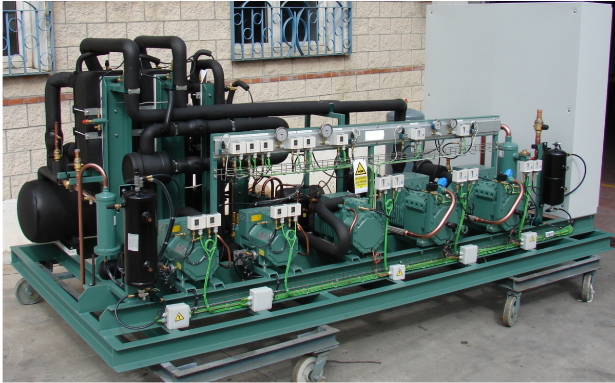
CENTRAL DE CO2 SUBCRÍTICA DE 3+2 COMPRESORES BITZER
