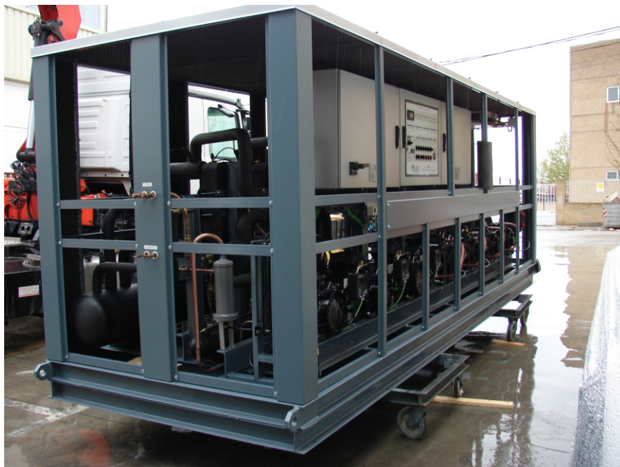
CENTRAL CARROZADA E INSONORIZADA EN CASCADE DE CO2/R134, CON COMPRESORES COPELAND CON CUADRO ELÉCTRICO MONTADO, MÁS EVAPORADOR INTERNO EN CARROZADO
