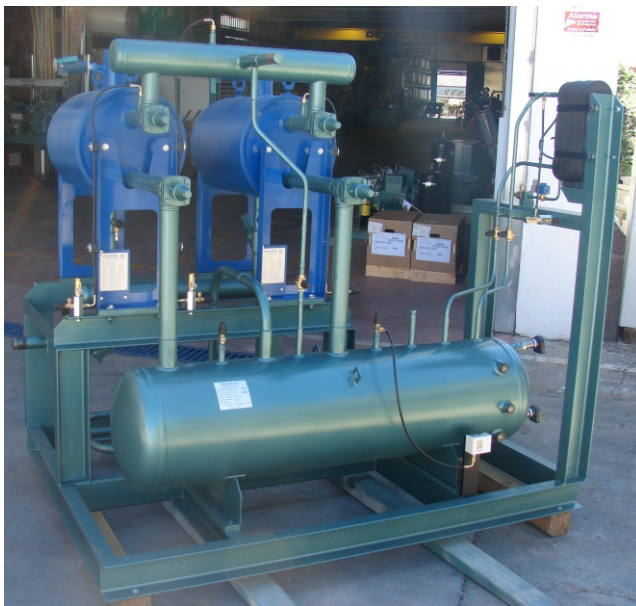
SISTEMA DE CONDENSACIÓN POR AMONIACO
